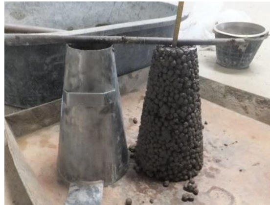
(ข) การทดสอบค่ายุบตัวที่ช่องว่างร้อยละ 90
