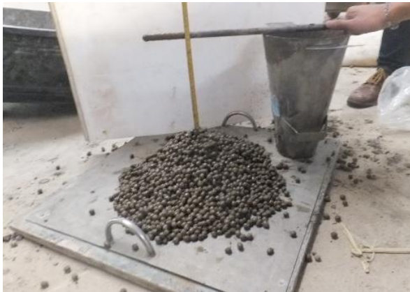
(ก) การทดสอบค่ายุบตัวที่ช่องว่างร้อยละ 70
