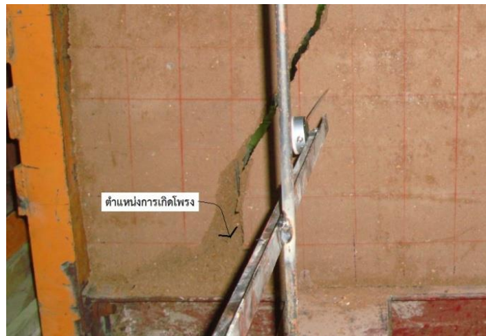
รูปที่ 5 : ด้านล่างของผนังดินซีเมนต์บดอัดเกิดเป็นโพรง
