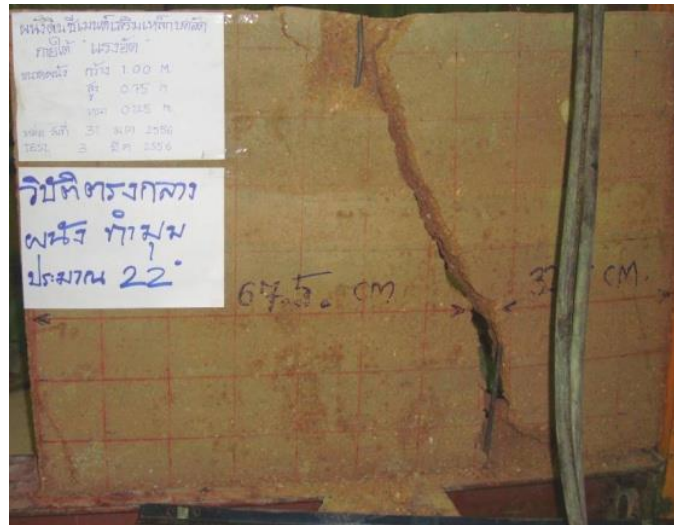
รูปที่ 6 : ลักษณะรูปแบบของการวิบัติของผนังดินซีเมนต์บดอัดด้านหน้า ตัวอย่างขนาด 12.5x75x100 เซนติเมตร
